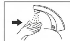
Activación automática por sensor infrarrojo inductivo
