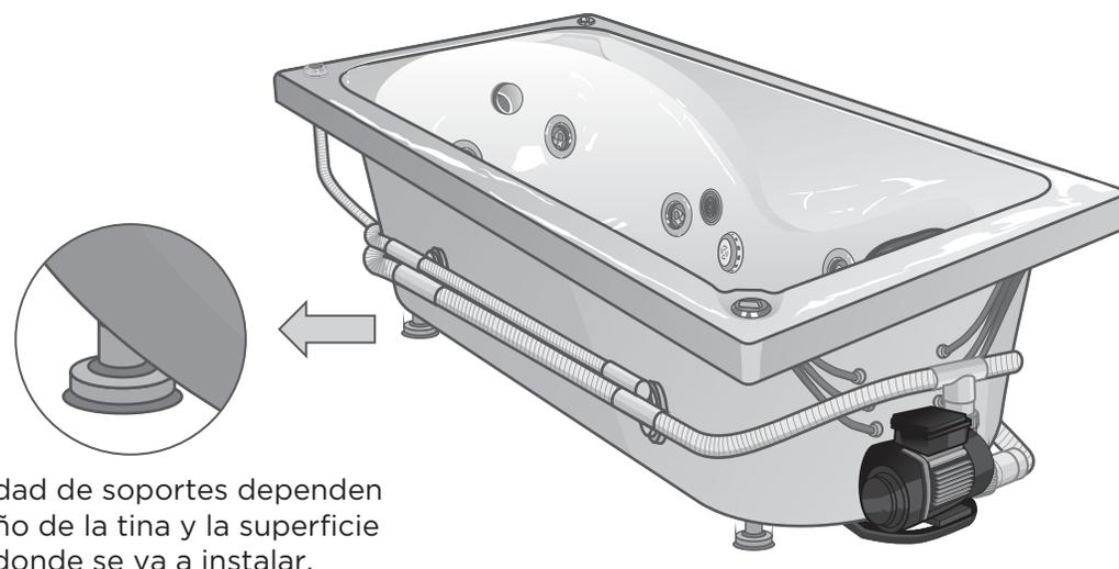
La cantidad de soportes dependen del diseño de la tina y la superficie en donde se va a instalar.
