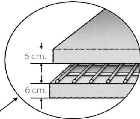
La ilustración muestra la forma en la que debe armarse el firme. Es necesario colocar dos capas de colado de un espesor de 6 cm. una arriba de otra, reforzada en su interior de un tramado metálico.
