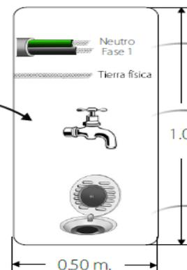
1. Conexión eléctrica 110V. con cable del No. 8 con tierra física conectada a una varilla copperweld.
