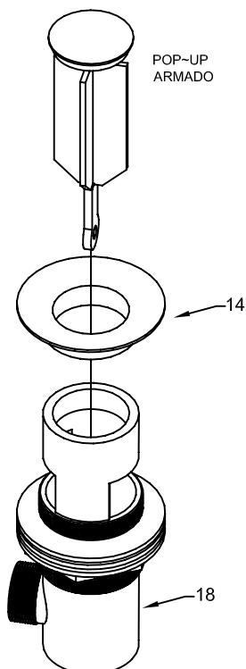
Inserte el cuerpo del desagüe desde la parte inferior de su lavabo y atornille la pieza 14 desde la parte superior del lavabo, asegure con el empaque y la tuerca desde la parte inferior, como se muestra en la figura.
