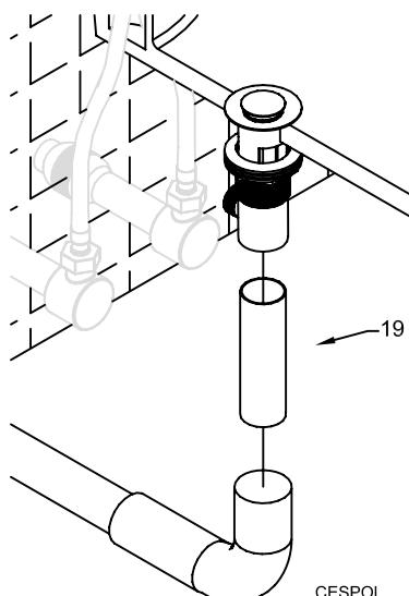
Con la válvula asegurada al lavabo conecte la pieza 19 en la parte inferior y realice la conexión al desagüe por medio del cespol en la pared.
