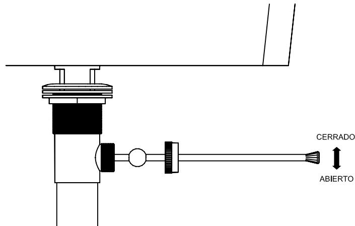
Para permitir el flujo de agua en el lavabo asegúrese de que el accesorio este colocado en la parte inferior.
