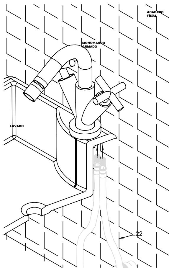
El otro extremo de las mangueras deberán ser conectadas a la línea de alimentación convencional, por medio de válvulas angulares no incluidas.
