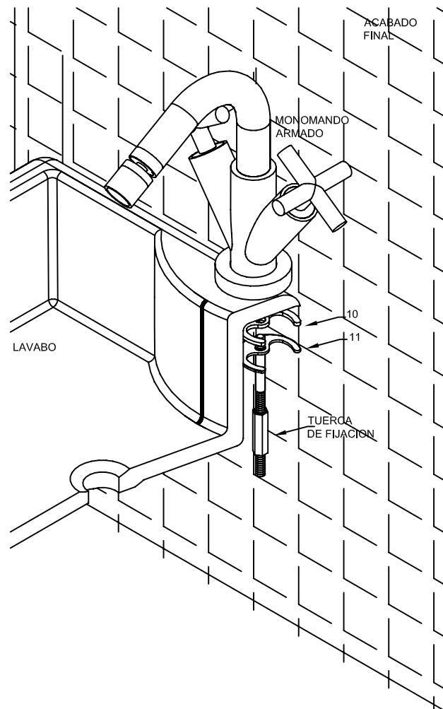
1.- Colocar el monomando ensamblado sobre la placa del lavabo, y enroscar la varilla de fijación desde la parte inferior.
